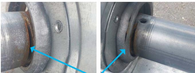
L'axe du rideau est cisailé par le rideau par manque de graissage et de contrôle
